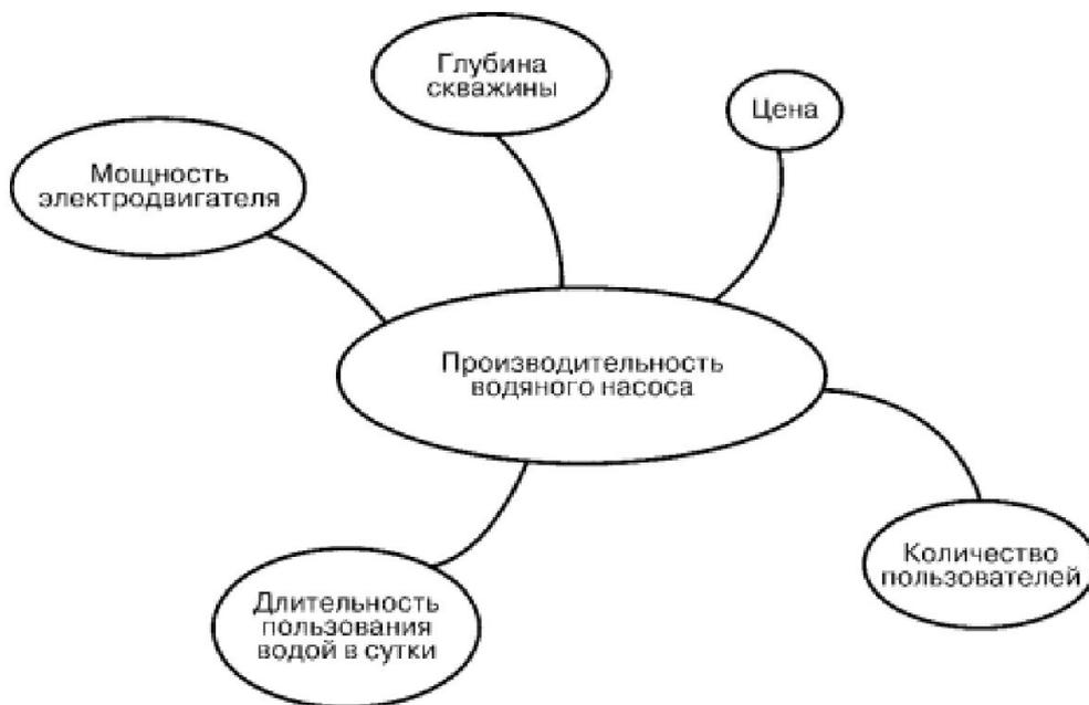
Рисунок 1 – Причинно-следственная диаграмма производительности водяного насоса
