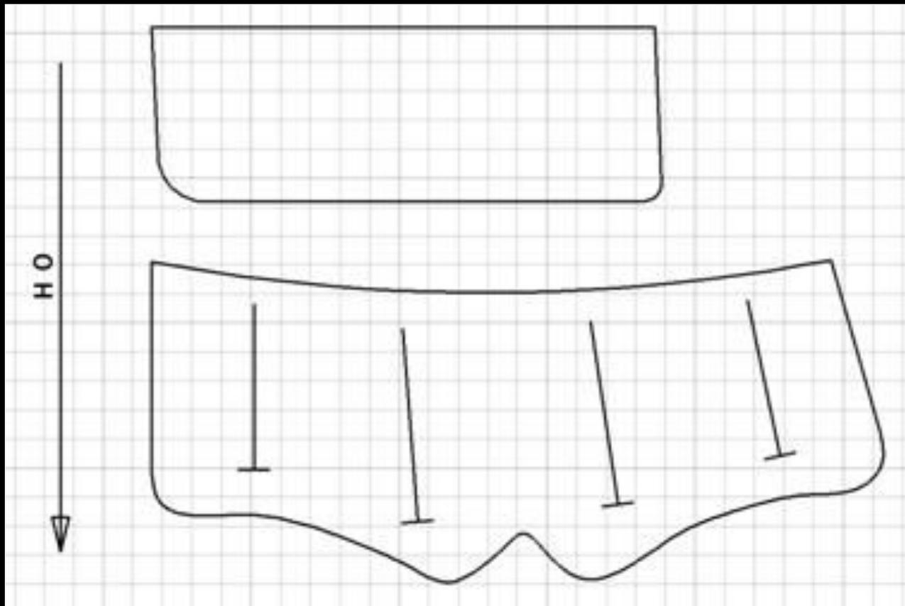
Чертежи конструкций клапанов кармана:
