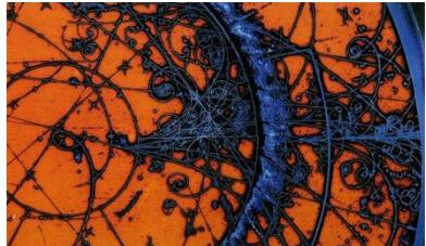
Фотография столкновения элементарных частиц в главной пузырьковой камере ускорителя Европейского центра ядерных исследований (ЦЕРН) в Женеве, Швейцария. Траектории движения элементарных частиц расцвечены для большей ясности картины. Голубыми линиями отмечены следы пузырьков, образующихся вокруг атомов, возбужденных в результате пролёта быстрых заряженных частиц.
