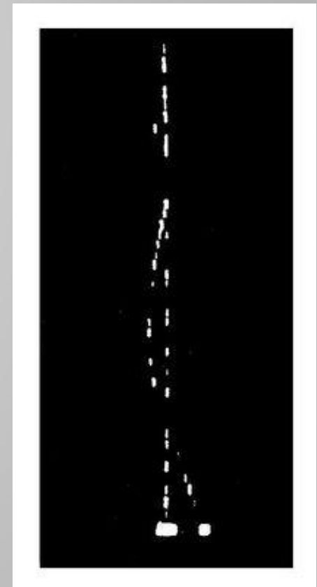
Трек частицы в узкоззорной искровой камере
