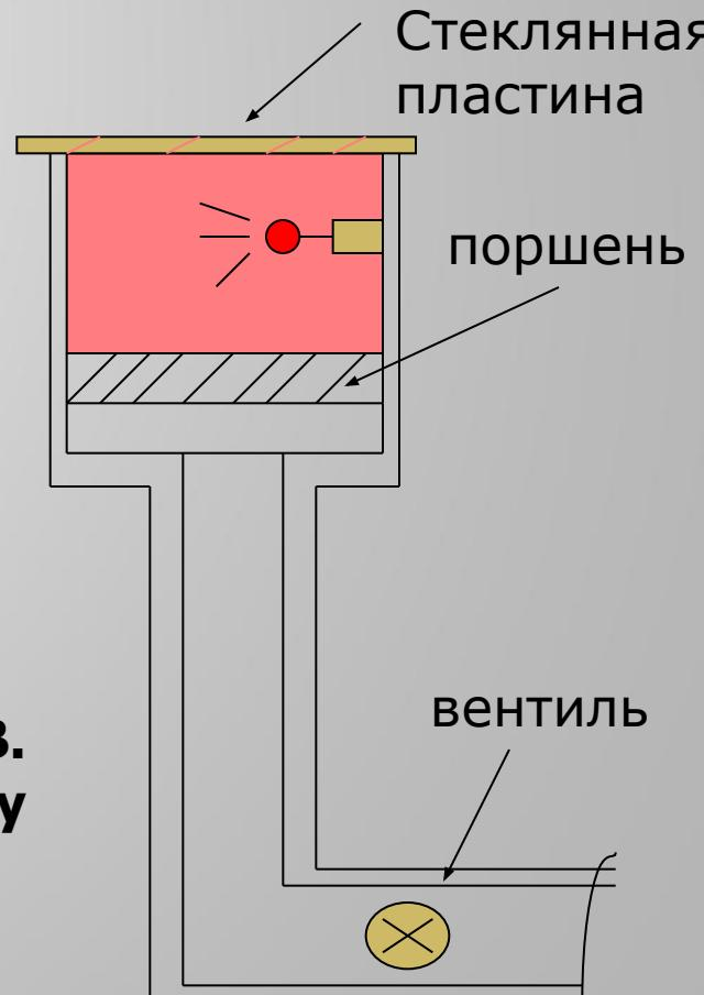
Если частицы проникают в камеру, то на их пути возникают капельки воды. Эти капельки образуют видимый след пролетевшей частицы - трек. По длине трека можно определить энергию частицы, а по числу капелек на единицу длины оценивается её скорость. Трек имеет кривизну.
