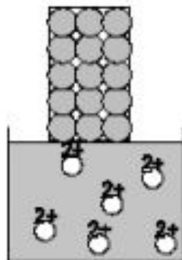
**Рис. 1.** Цинковая пластинка в растворе сульфата меди.
