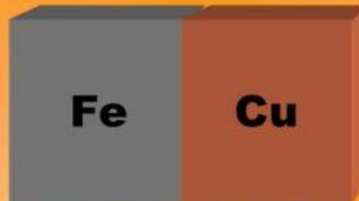
На аноде (более активном металле) идет **окисление** атомов  $Me$  с образованием катионов (растворение)
