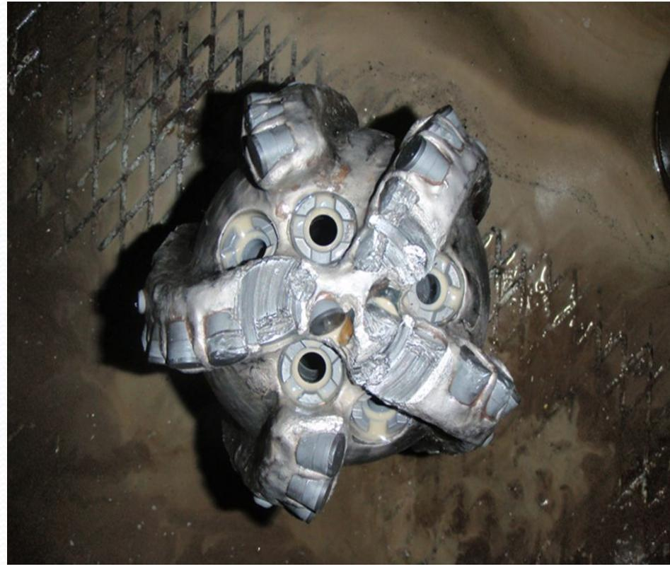
Долото РДС с комбинированным вооружением из линейки «BULAVA»
