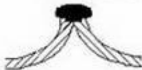
Сварка с отбортовкой
