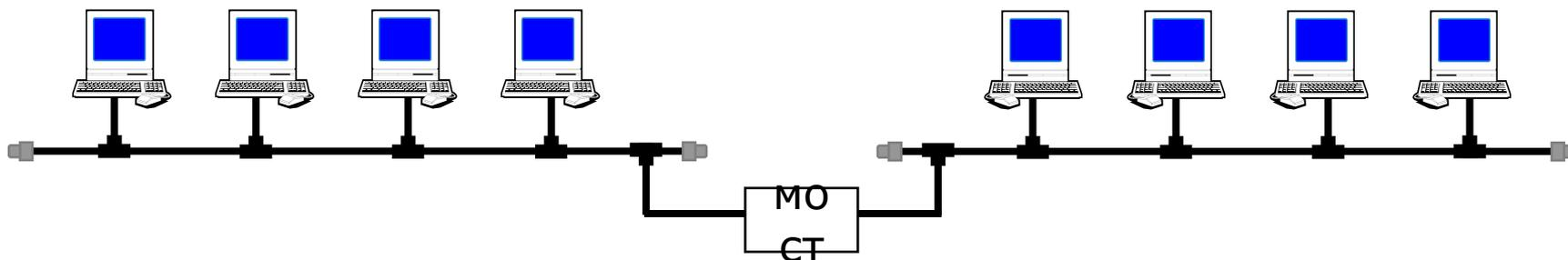
Вариант: компьютер с двумя сетевыми картами.
