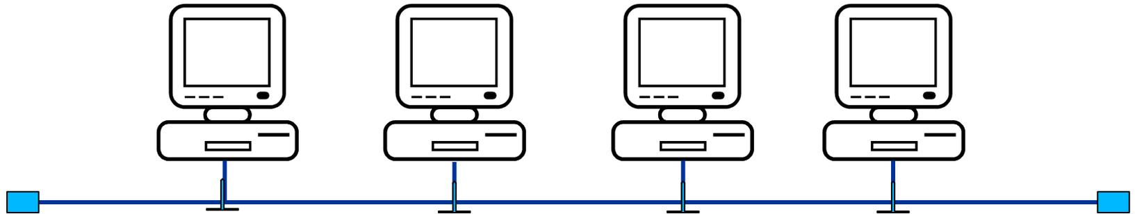
**Все компьютеры подключаются к одному кабелю (шине). На концах (узлах) терминатор**
