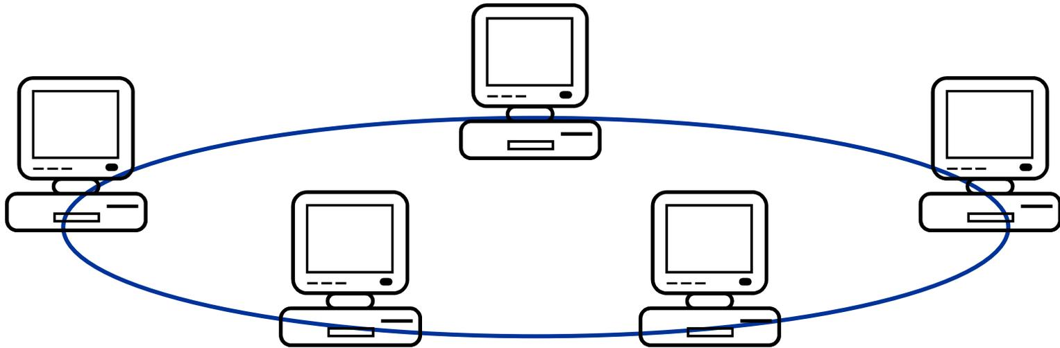
При топологии «кольцо» **компьютеры подключены последовательно друг к другу, образуя замкнутую сеть.**
