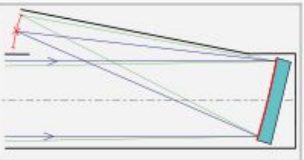
Оптическая схема телескопа Гершеля
