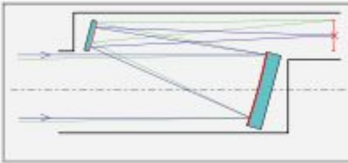
Оптическая схема брахита
