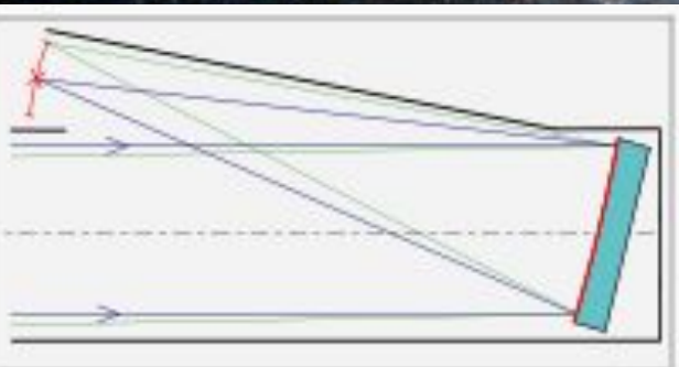
Оптическая схема телескопа Гершеля
