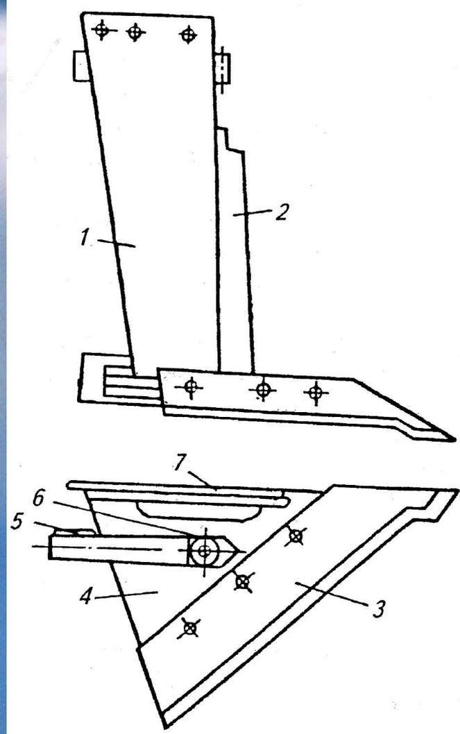
**Усовершенствованная лапа подрезная ЛП-035
