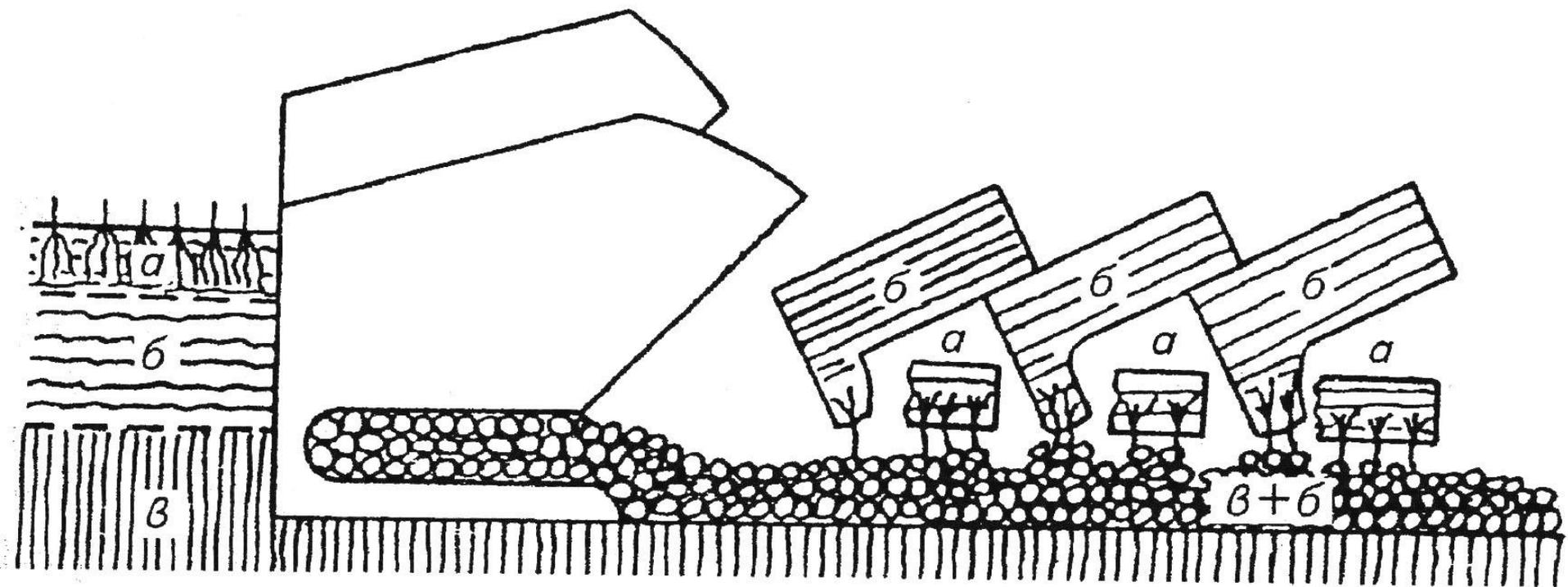
**Схема вспашки плугом с вырезным отвалом и с предплужником:**
