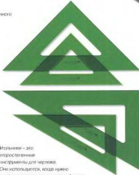
Угольники – это второстепенные инструменты для чертежа. Они используются, когда нужно вписать некоторые элементы в фигуру или измерить углы при создании чертежа.
