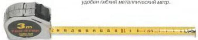
Для того чтобы измерить длину до 50 м, используется измерительная рулетка с гибкой тканевой или металлической лентой.
