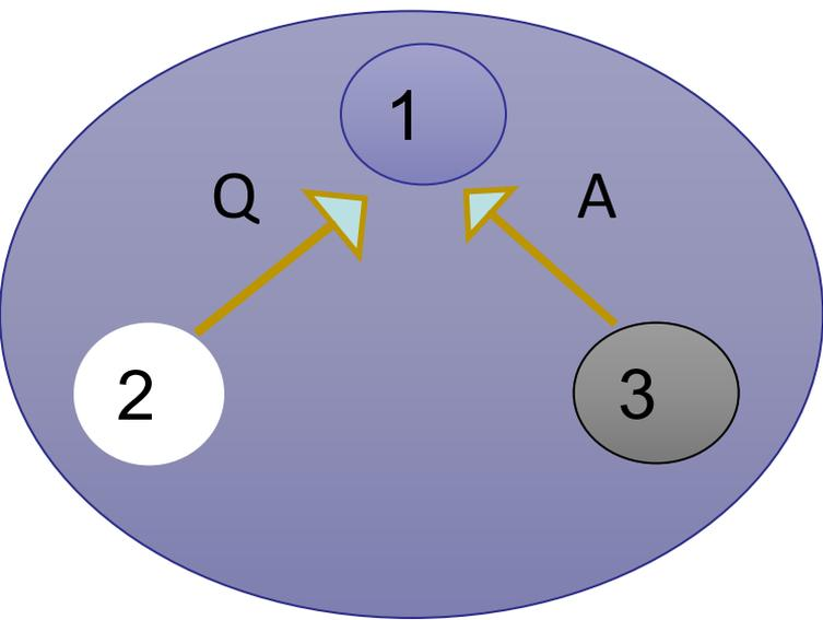
При теплопередаче количества теплоты  $Q$  внутр. энергия тела 2 из-ся на  $\Delta U_2 = -Q$
