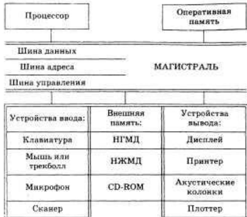
Схема магистрально-модульного принципа построения ПК
