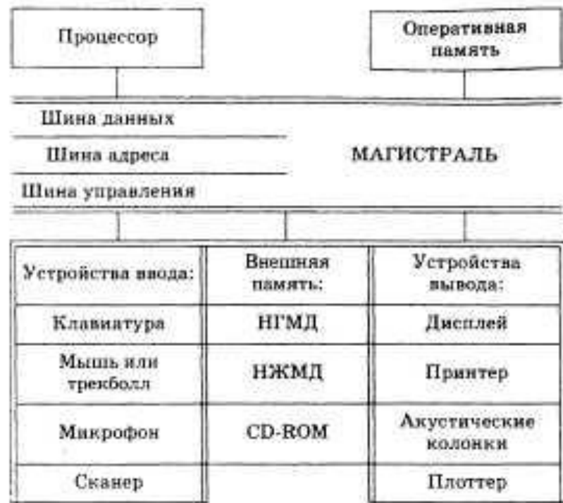
Схема магистрально-модульного принципа построения ПК
