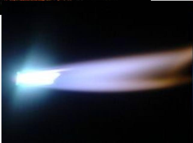
Источником теплоты является газовый факел, образующийся при сгорании смеси кислорода и горючего газа. В качестве горючего газа могут быть использованы ацетилен, водород, пропан, бутан, блаугаз, бензин, бензол, керосин и их смеси.
