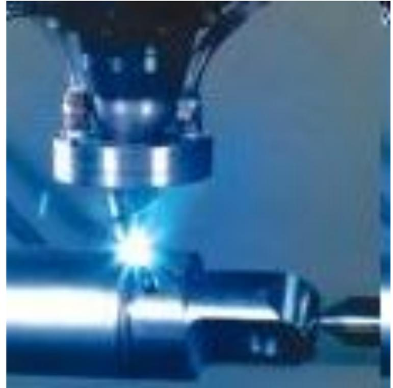
Источником теплоты служит лазерный луч.
