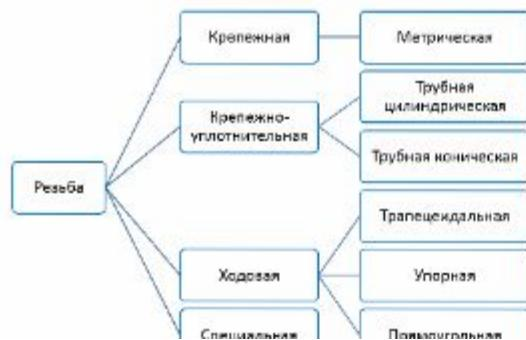
**Крепежные резьбы** предназначены для прочного и плотного соединения деталей
