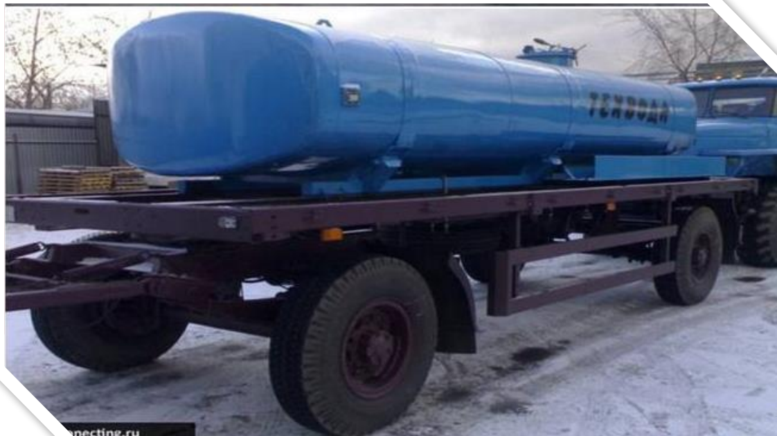
Рисунок 1 – Цистерны, устанавливаемые на шасси грузовых автомобилей и прицепного состава
