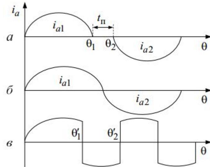
Характеристики основных зависимостей последовательного резонансного инвертора и последовательного инвертора тока также весьма похожи:
