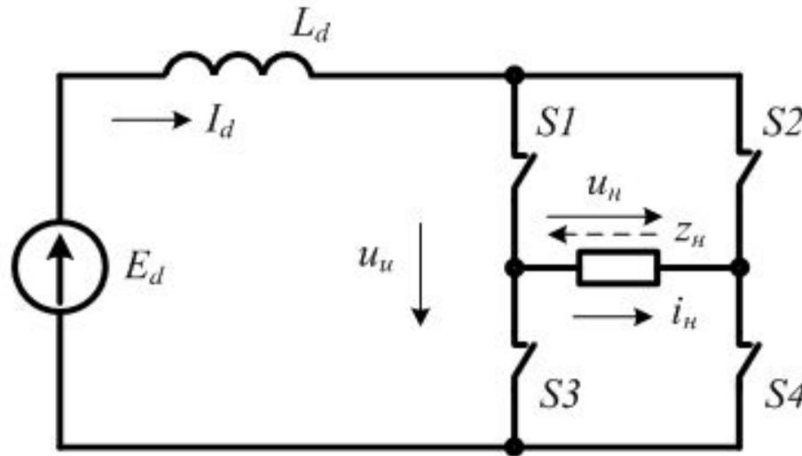
Источник напряжения  $E_d$  работает в режиме источника тока, поскольку последовательно с ним включен реактор  $L_d$  с бесконечной величиной индуктивности. В этом случае пульсациями входного тока  $I_d$  можно пренебречь и считать его идеально сглаженным. Переключения в схеме инвертора осуществляются с помощью ключей  $S1-S4$ . Их функция сводится к периодическому изменению направления тока  $i_n$  в цепи нагрузки  $z_n$ .
