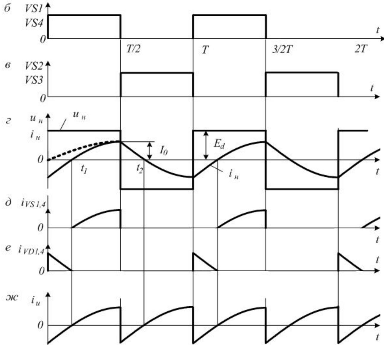
В конце первого интервала работы инвертора:  $0 - T/2$  ток нагрузки возрастает от нуля до величины  $I_0$  (показано пунктиром на рисунке **з**) и имеет положительное направление.
