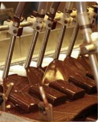
При глазировании закаленное мороженое окунается в растопленную при  $34-37^{\circ}\text{C}$  глазурь собственного производства, обсушивается на воздухе 20-25 секунд и с помощью робота подается на упаковочную машину.
