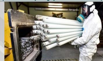
Отгонка ртути на аппарате термовакuumной дистилляции
