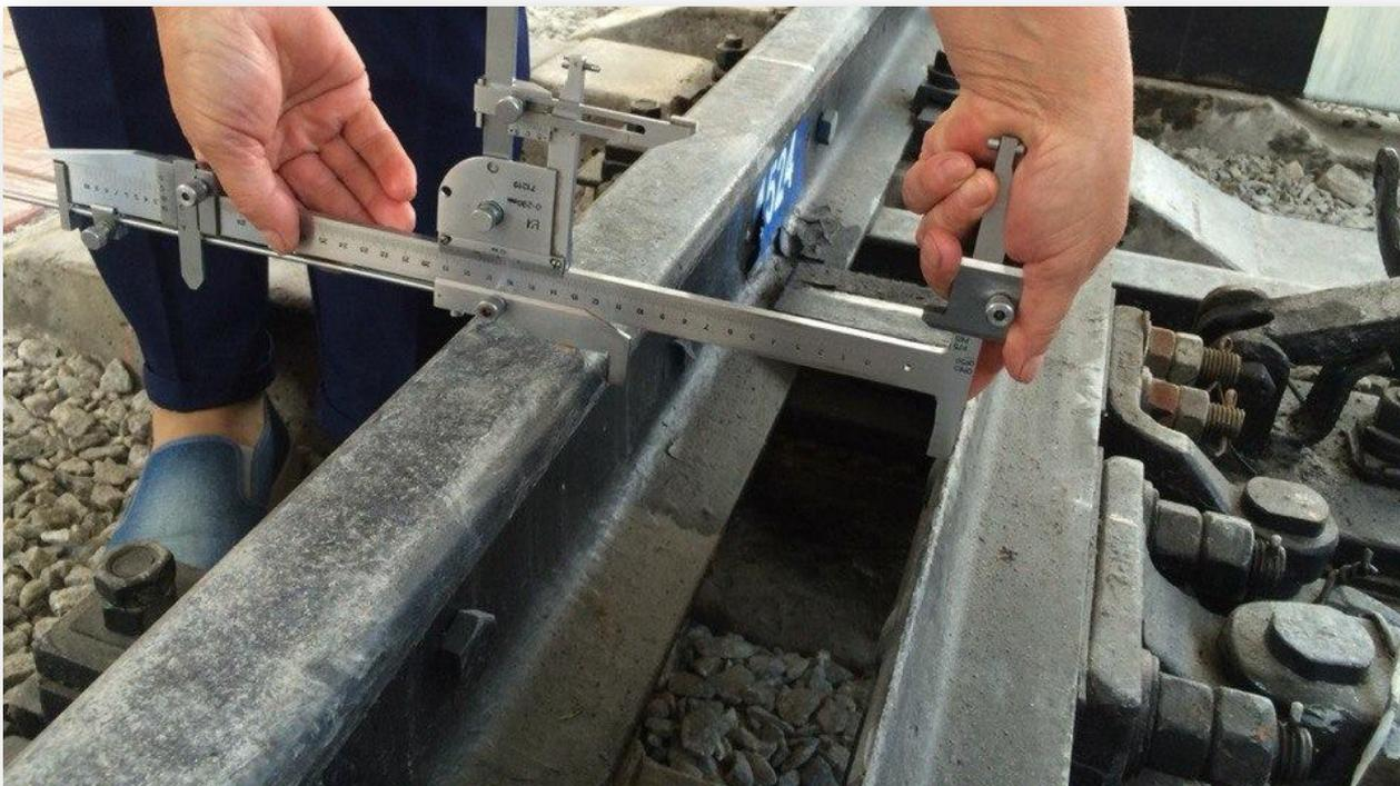
Шаг подвижных сердечников острых крестовин с непрерывной поверхностью катания устанавливается технической документацией на эти крестовины.
