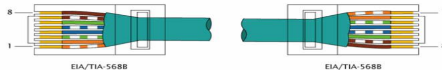
Вариант по стандарту TIA/EIA-568B (используется чаще)
