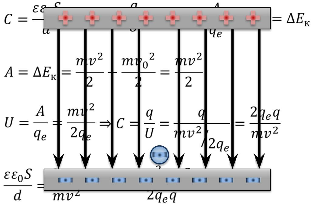
Изначально покоящийся электрон, пролетев от одной пластины конденсатора до другой, развил скорость  $5 \times 10^6$  м/с. Заряд конденсатора составляет 2 нКл, а диэлектрическая проницаемость диэлектрика равна 2. Если площадь пластины конденсатора равна  $5 \text{ см}^2$ , то, каково расстояние между пластинами?
