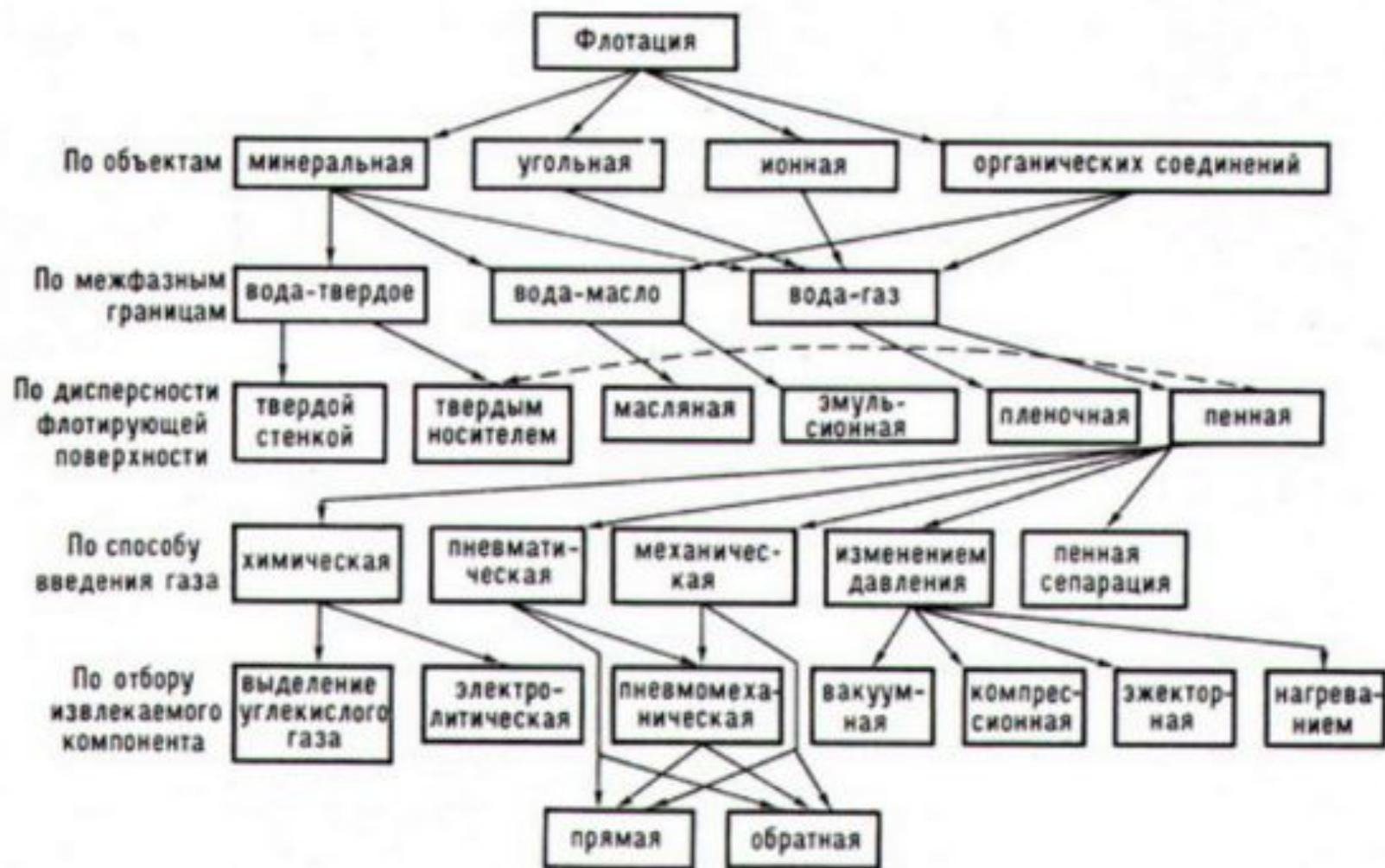
ФЛОТАЦИЯ — процесс разделения мелких твёрдых частиц (главным образом минералов) в водной суспензии (пульпе) или растворе, основанный на избирательной концентрации (адсорбции) частиц на границах раздела фаз в соответствии с их поверхностной активностью или [смачиваемостью](#). Гидрофобные (плохо смачиваемые водой) частицы избирательно закрепляются на границе раздела фаз (обычно газа и воды) и отделяются от гидрофильных (хорошо смачиваемых водой) частиц.
