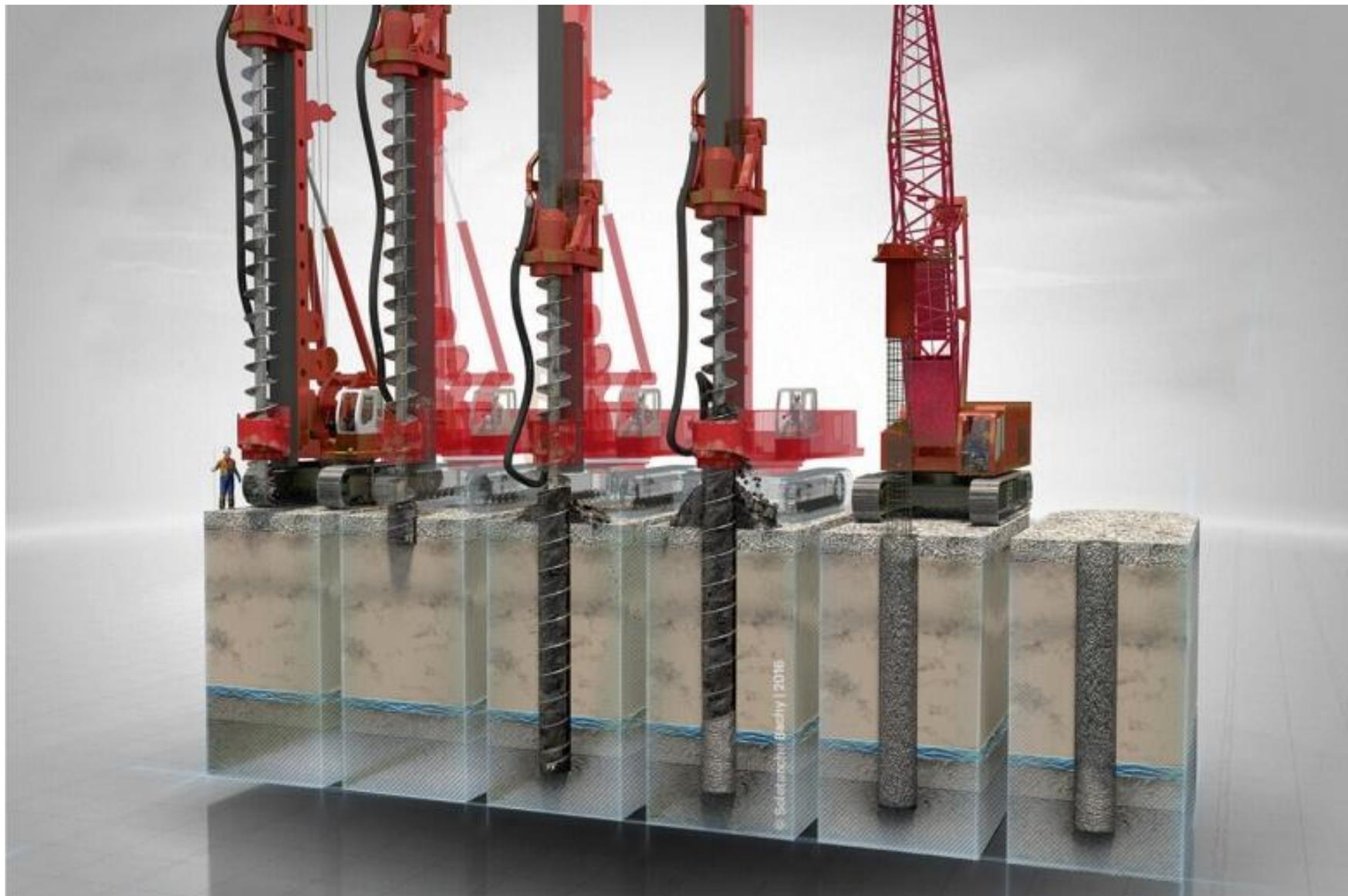
Рис. 4. Технологическая схема устройства грунтобетонных свай
