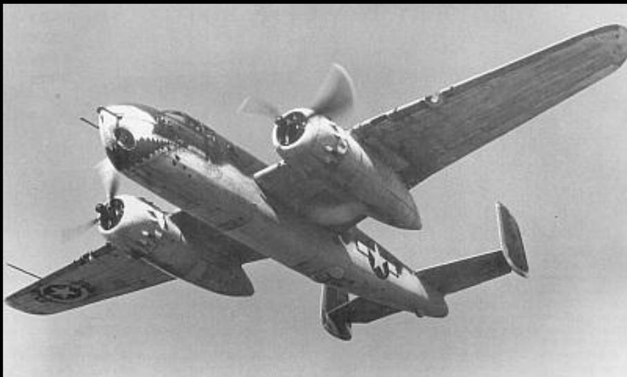
Фюзеляж самолета состоял из четырех секций: носовой, передней, центральной и хвостовой. Конструкция фюзеляжа состояла из шпангоутов, лонжеронов и обшивки, соединенных заклепками. Ширина фюзеляжа составляла всего 144 см, то есть ровно столько, чтобы втиснуть рядом двух пилотов. В особенностях конструкции данного самолета выделяют следующие аспекты:
