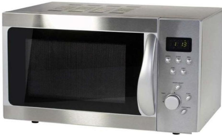
В микроволновой печи происходит диэлектрический нагрев веществ, содержащих полярные молекулы. Электрическая компонента электромагнитных волн ускоряет движение молекул, обладающих дипольным моментом, а межмолекулярное взаимодействие приводит к поглощению электромагнитного излучения и увеличению температуры вещества.
