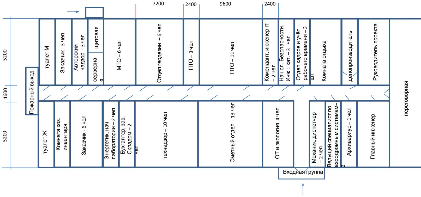
Здание 57,6\*12 м, быстровозводимое на основе модулей 6\*2,4 с инженерными сетями
