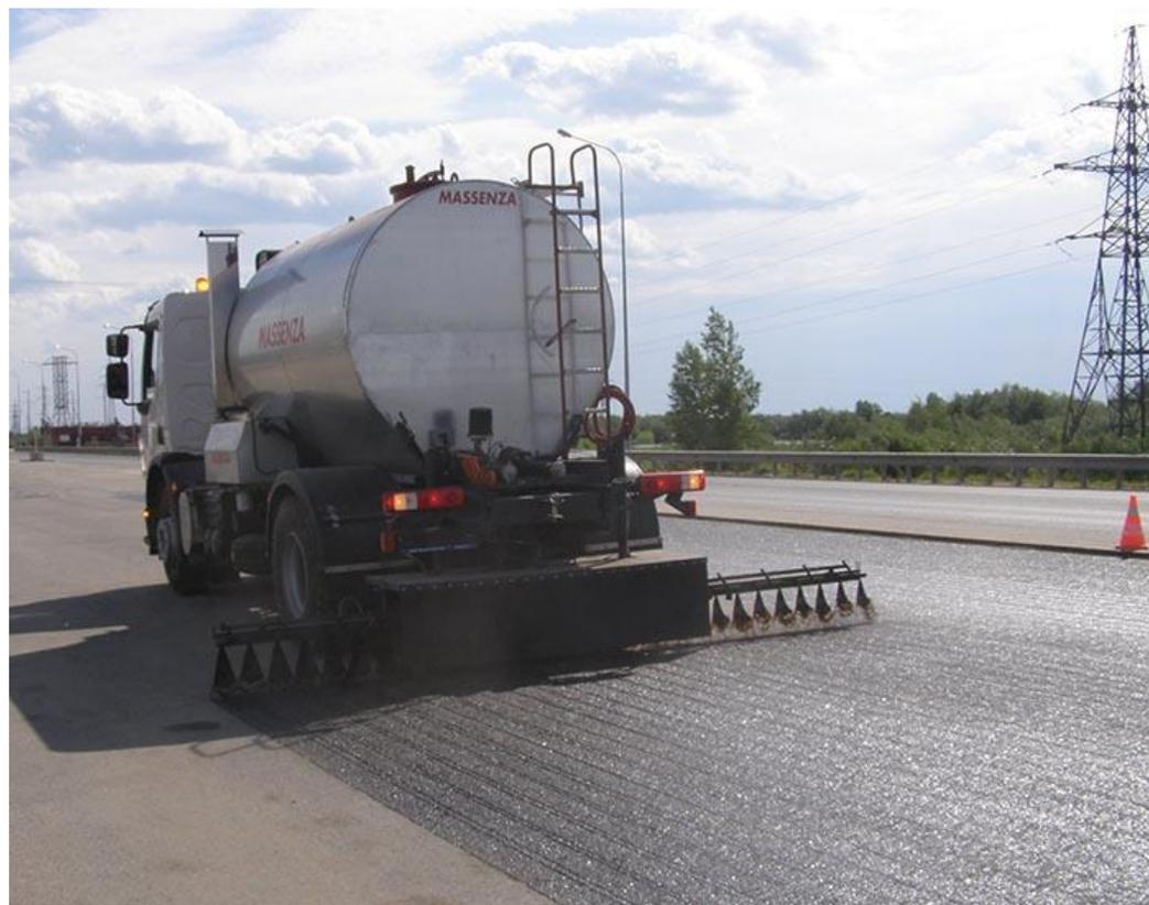
Рабочие операции в автогудронаторе осуществляются с помощью насоса. Компрессорные гудронаторы наполняются в результате разрежения, создаваемого в цистерне с помощью компрессора, а распределение производится под давлением сжатого воздуха в цистерне.
