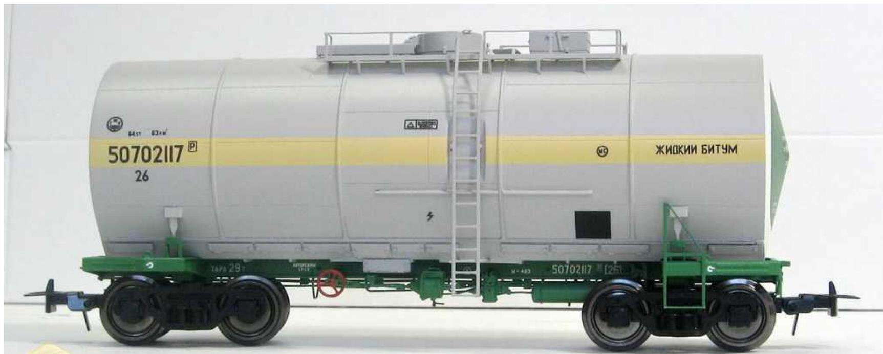
Для транспортирования битума по железной дороге применяются цистерны грузоподъемностью 50–60 т и более, или бункерные полувагоны грузоподъемностью 40–60 т (4-6 секций по 10 т).
