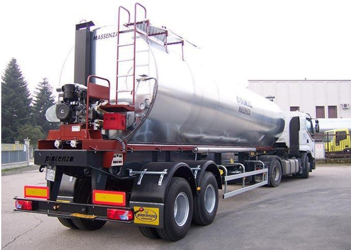
**Автобитумовоз предназначен для транспортирования и разогрева битума и своей системы распределения не имеет. Он может работать с прицепным гудронатором.**
