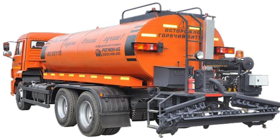
Для распределения на поверхности дорожного покрытия битумных вяжущих материалов как горячих (битум, деготь), так и холодных (эмульсии, разжиженные битумы и деги, мазут, нефть) ровным слоем в определенных количествах (от 0,5 л/м<sup>2</sup> и более) предназначены **гудронаторы**.
