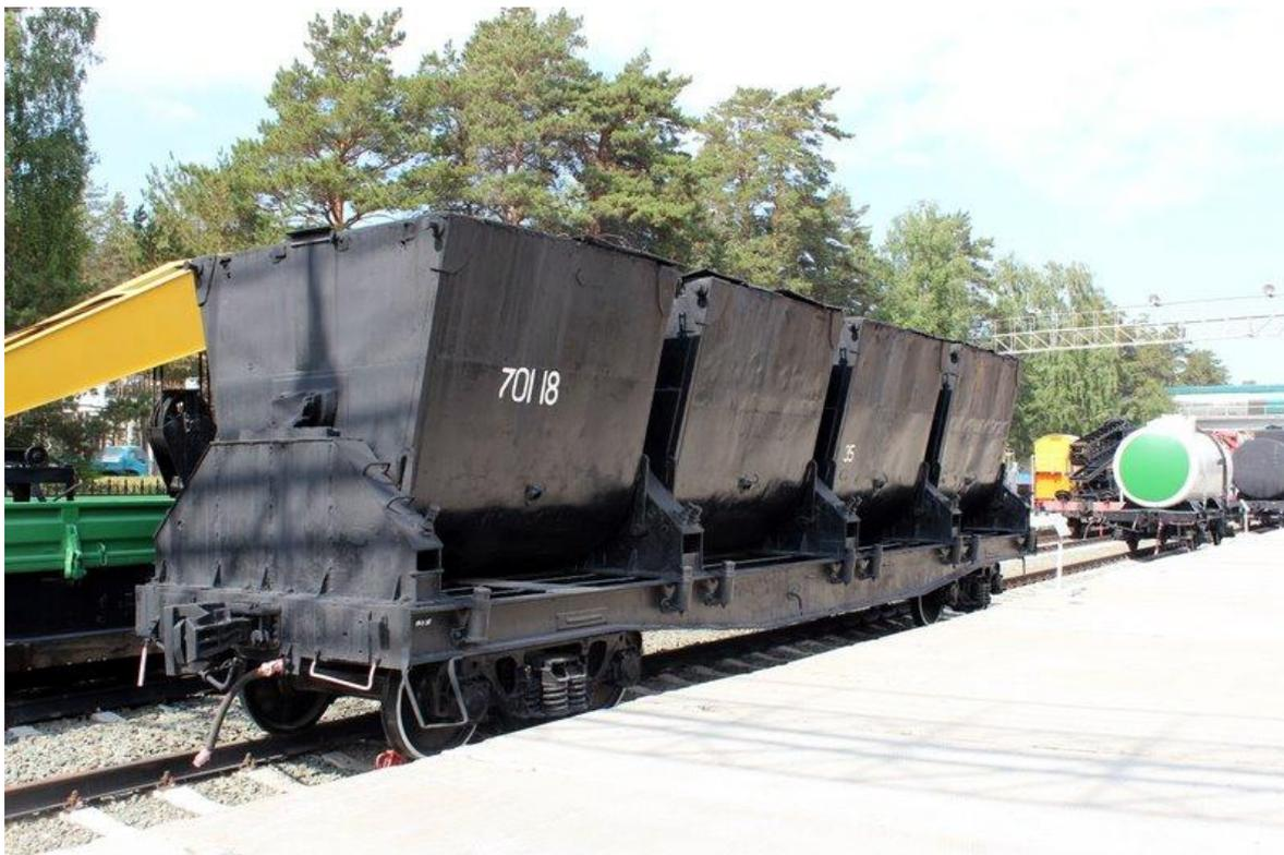
Железнодорожные и автомобильные цистерны и бункерные полувагоны имеют, как правило, теплоизоляцию и устройства для разогрева битума (паром – змеевиками или острым паром, топочными газами, электроэлементами или масляный подогрев). Бункерные полувагоны разогреваются паром, для пропуска которого имеют двойные стенки с расстоянием между ними 40–50 мм.
