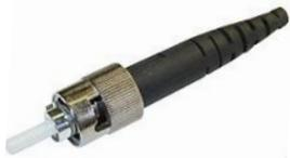
Разъем типа ST использует быстро сочленяемое байонетное соединение, которое требует поворота разъема на четверть оборота для осуществления соединения/разъединения. Применяется как для одномодового, так и для многомодового кабеля. Самый дешевый разъем
