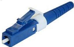
Разъем типа LC миниатюрный вариант SC. Он обеспечивает еще большую плотность монтажа. Помещен в прочный термостойкий пластмассовый корпус типа с механизмом «push-pull». Может использоваться для дуплексного соединения.
