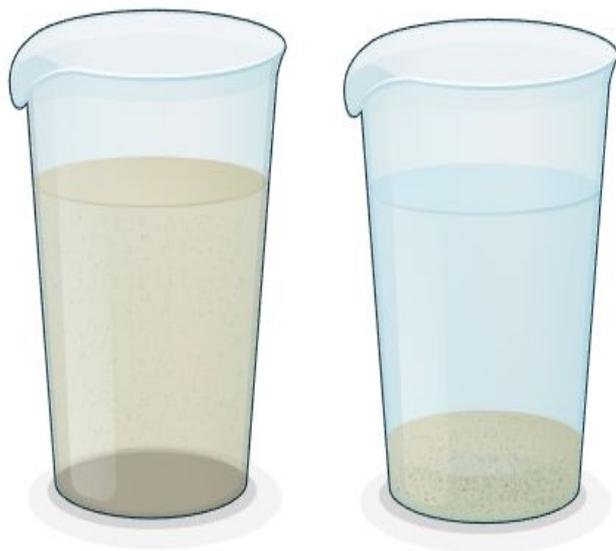
Рис. 1. Отстаивание смеси песка и воды
