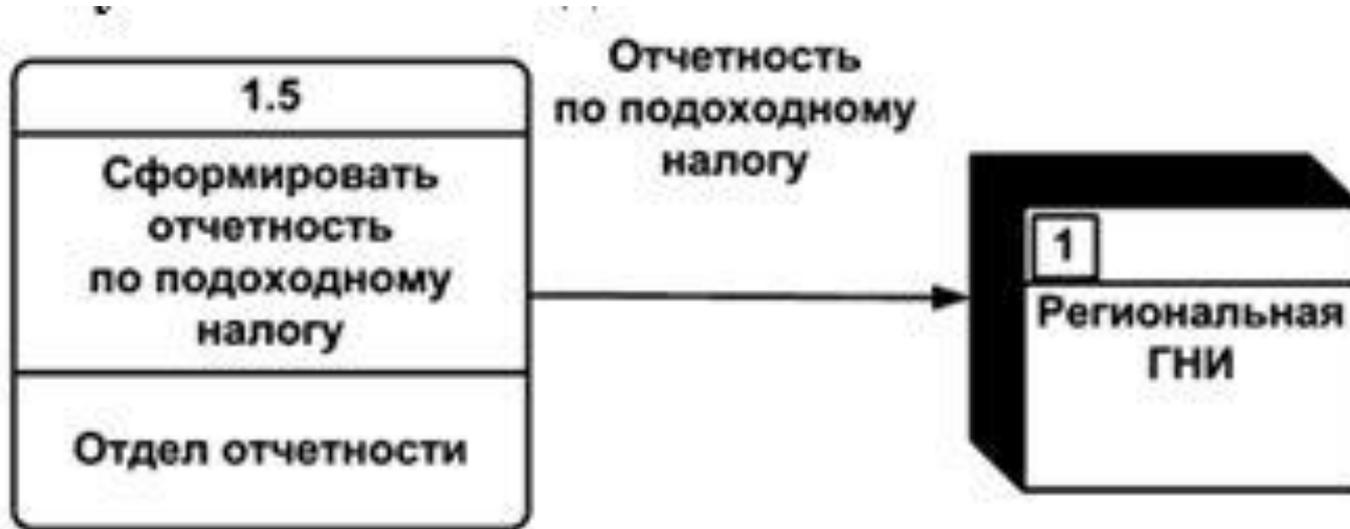
Поток данных изображается линией, оканчивающейся стрелкой, которая показывает направление потока и имеет имя, отражающее его содержание.
