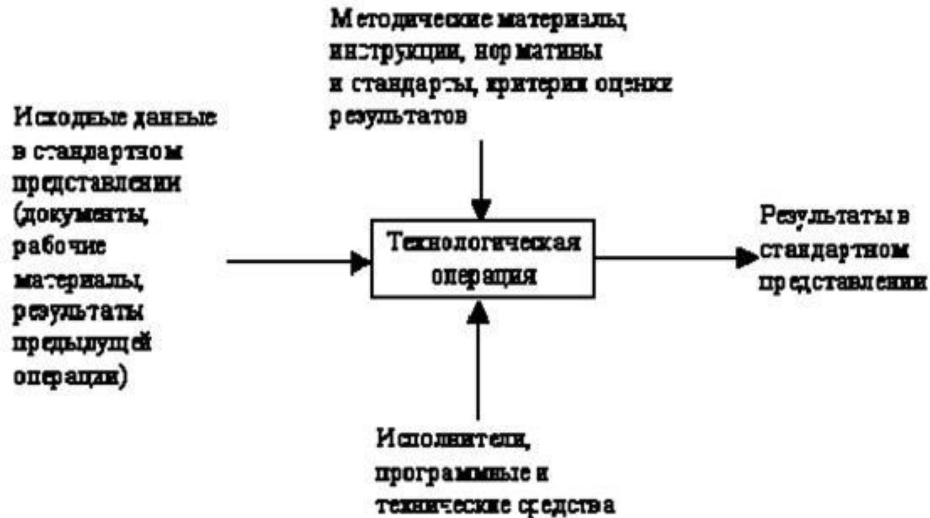
Функциональный блок и интерфейсные дуги
