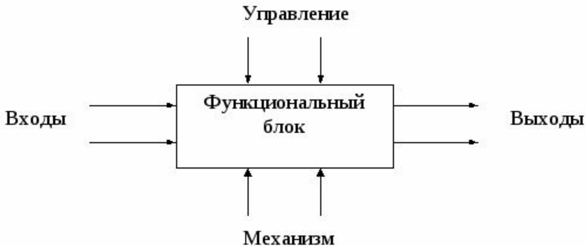
Рис. 3.8. Функциональный блок SADT-диаграммы
