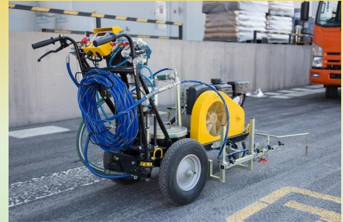
Машина дорожная разметочная «Контур 30»
