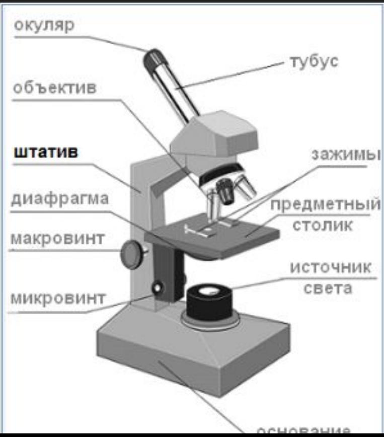
Корпус микроскопа образуют **основание** и **штатив**.
