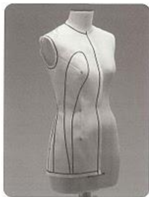
●ボディを縫い上げ、ダーツ止り、ウエストラインに●印をつける。 ●の位置に簡単に自由にラインを入れる。縫い合わせるときのために、合い印も入れておく。
