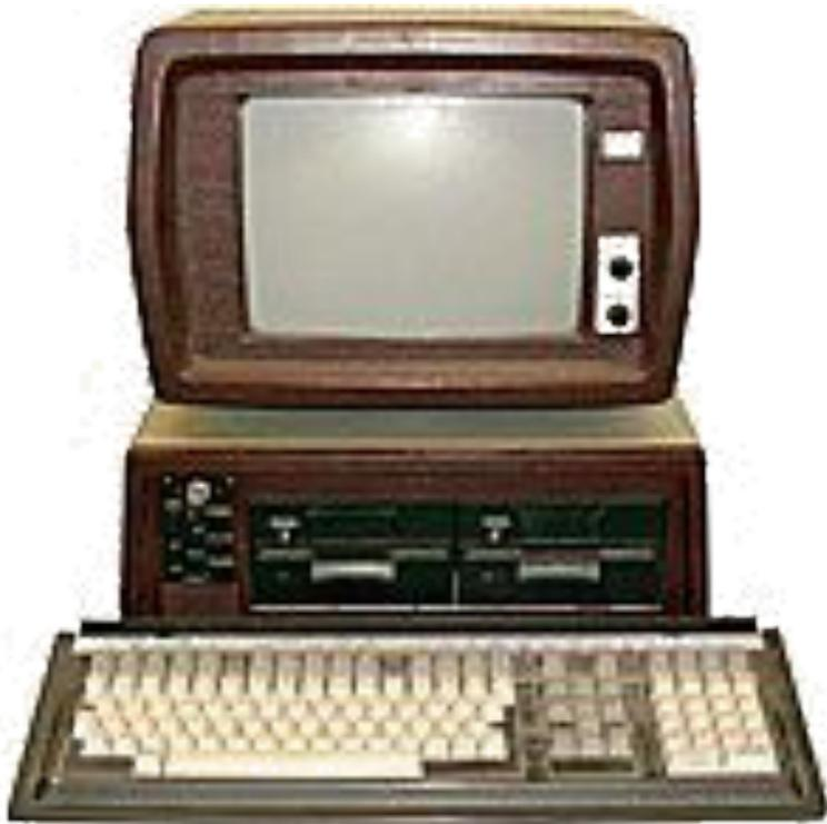
Диалоговые вычислительные комплексы (ДВК) “Электроника МС 0501” и “Электроника МС 0502” и «**Электроника МС 0507**» были предназначены для работы в системах управления технологическими процессами и автоматизированного проектирования.
