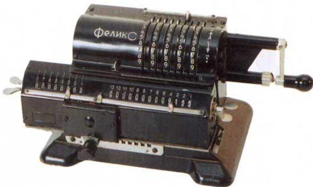
**Арифмометр** является ручной вычислительной машиной, предназначенной для выполнения арифметических действий, в основном деления и умножения. Счетная емкость установочного механизма 9 разрядов. Счетная емкость результатного счетчика 13 разрядов. Счетная емкость счетчика оборотов 8 разрядов.
