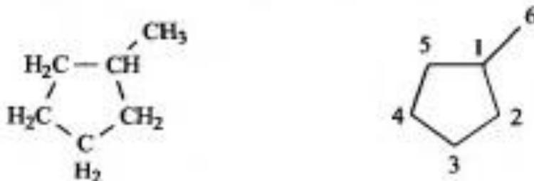
Рис. 15. Молекулярная структура и соответствующий топологический граф метилциклопентана.
