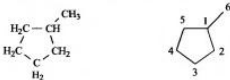
Рис. 15. Молекулярная структура и соответствующий топологический граф метилциклопентана.
