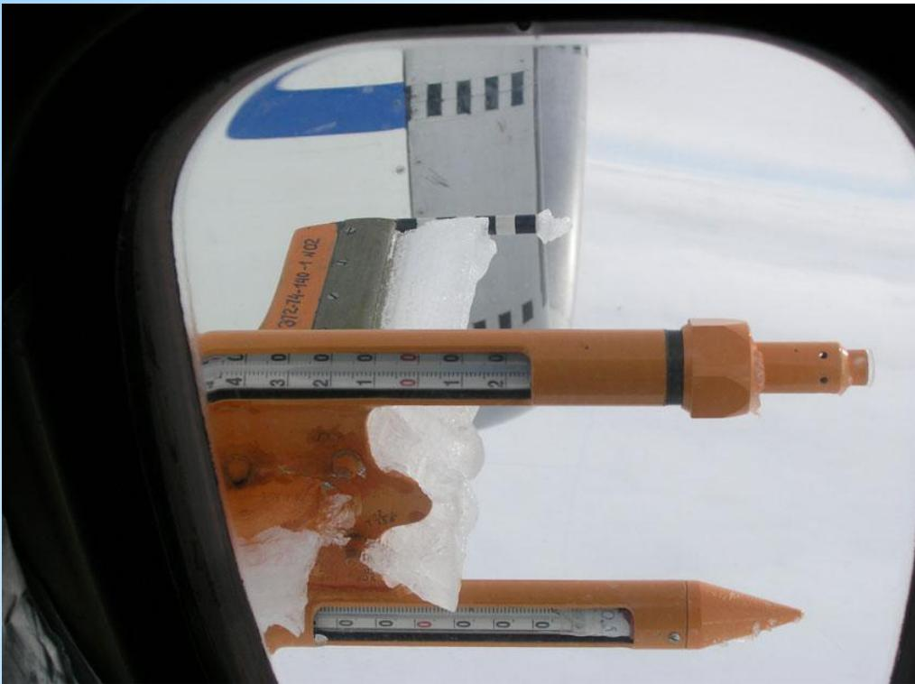
\* Толщина корки льда на передних кромках крыла может достигать 30-50 мм. Обледенение приемников воздушных давлений и температуры, датчиков направления воздушного потока (датчиков угла атаки и скольжения) нарушает работу приборных комплексов и систем, лишает экипаж важнейшей полетной информации.
