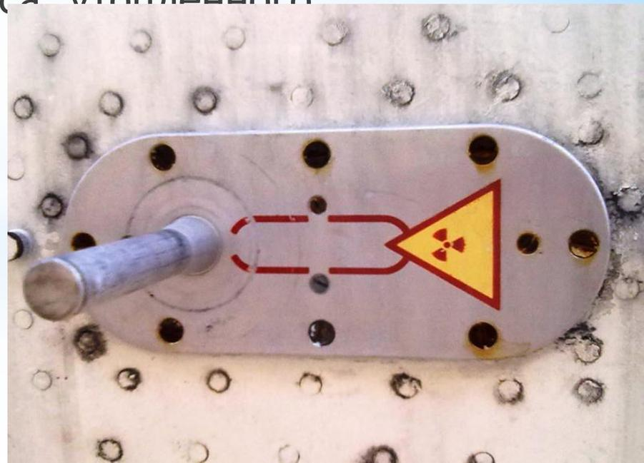
\* Если на штыре образуется слой льда, то частицы излучения реже проникают к детектору. Это свидетельствует о росте толщины ледяного покрова самолета. При достижении толщины льда 0,3 мм, включается обогрев датчика, и лед тает. После удаления льда восстанавливается проницаемость среды для В-излучения и сигнализатор приходит в исходное состояние. Датчик -сигнализатор данного типа используется для автоматического включения некоторых противообледенительных систем (ПОС).
