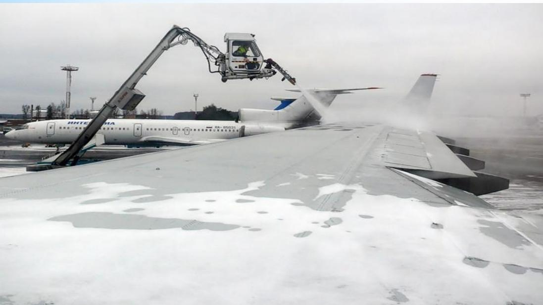
\* На земле обледенение самолета возможно в результате намерзания на его поверхности переохлажденного дождя или мокрого снега, поэтому самолет обычно зачехляют во время стоянки, а перед полетом обрабатывают специальной жидкостью (Г).
