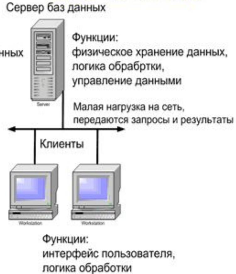
Модель «файл - сервер» и двухуровневая архитектура «клиент- сервер»
