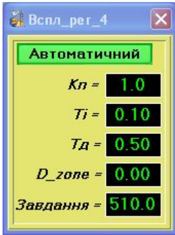
Рисунок 1 - Панель параметрів регулятора у автоматичному режимі
