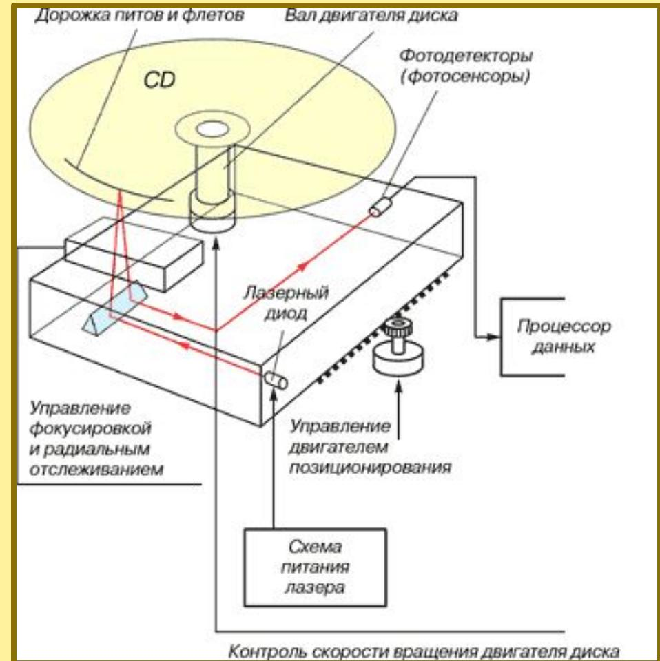
Схема устройства лазерного дисковода
