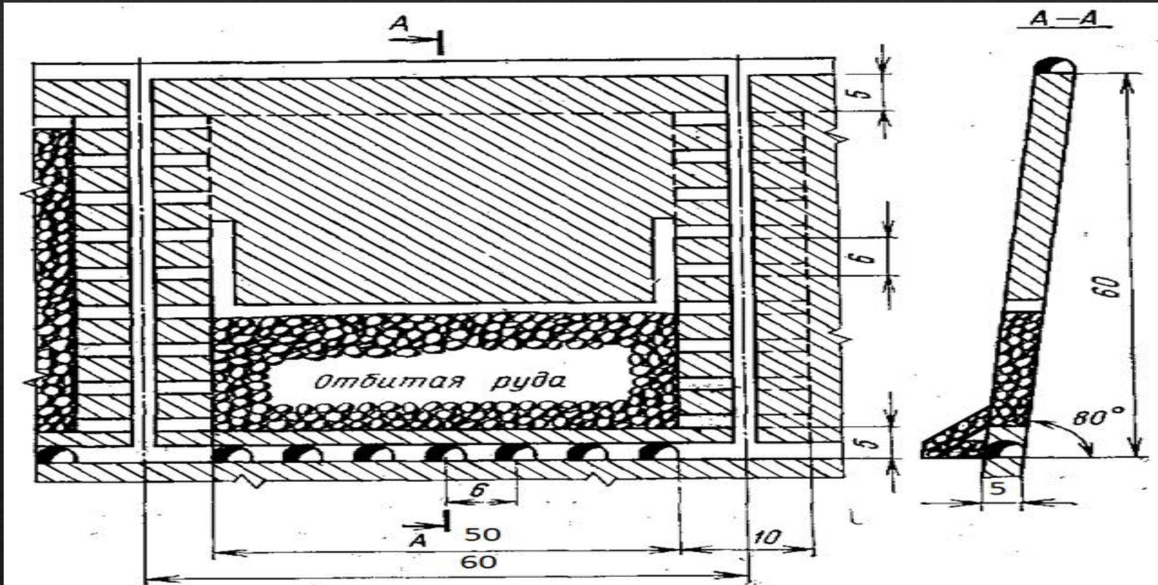
Сущность данной системы разработки заключается в том, что по мере выемки руды из блока в очистном пространстве оставляется отбитая руда для поддержания выработанного пространства.
