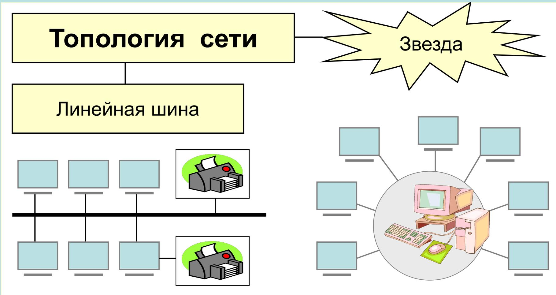
Общая схема соединения компьютеров в локальной сети называется топологией сети. Вариант соединения компьютеров, когда кабель проходит от одного компьютера к другому, последовательно соединяя компьютеры и периферийные устройства между собой, называется ЛИНЕЙНАЯ ШИНА. Если к каждому компьютеру подходит отдельный кабель из одного центрального узла, то реализуется локальная сеть типа ЗВЕЗДА. Обычно при такой схеме соединения центральным узлом является более мощный компьютер.
