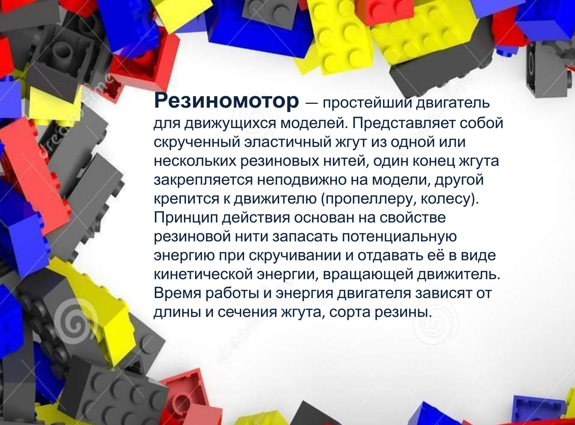
**Резиноmotor** — простейший двигатель для движущихся моделей. Представляет собой скрученный эластичный жгут из одной или нескольких резиновых нитей, один конец жгута закрепляется неподвижно на модели, другой крепится к движителю (пропеллеру, колесу). Принцип действия основан на свойстве резиновой нити запасать потенциальную энергию при скручивании и отдавать её в виде кинетической энергии, вращающей движитель. Время работы и энергия двигателя зависят от длины и сечения жгута, сорта резины.
