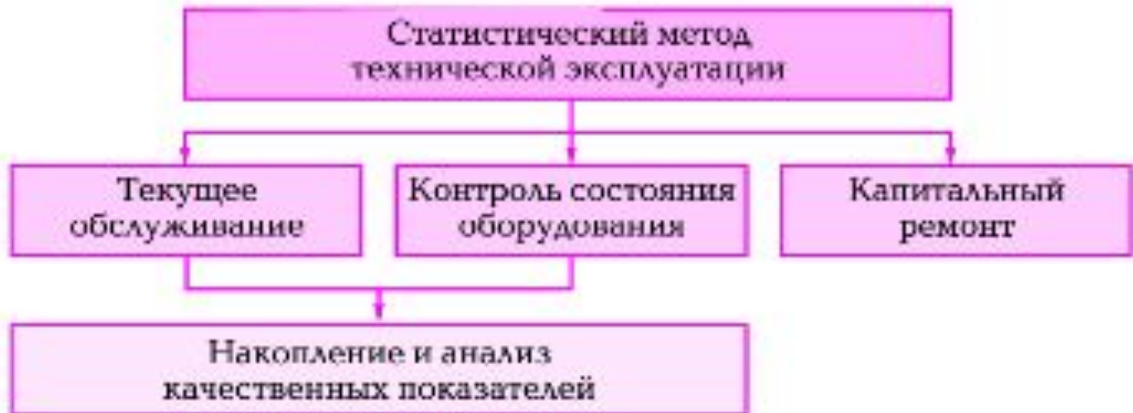
Рис. 2.1. Структура контрольно-корректирующего метода ТО
