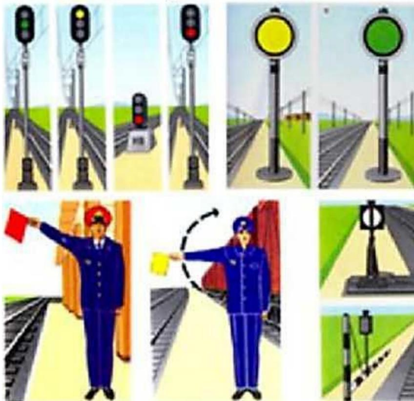
Сигналы служат для обеспечения безопасности движения поездов, а также для чёткой организации движения поездов и маневровой работы (Прил. №3
