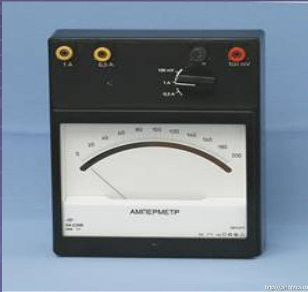
Шкалу А. градуируют в килоамперах, миллиамперах или микроамперах в соответствии с пределами измерения прибора. В электрическую цепь А. включается последовательно; для увеличения предела измерений — с шунтом или через трансформатор
