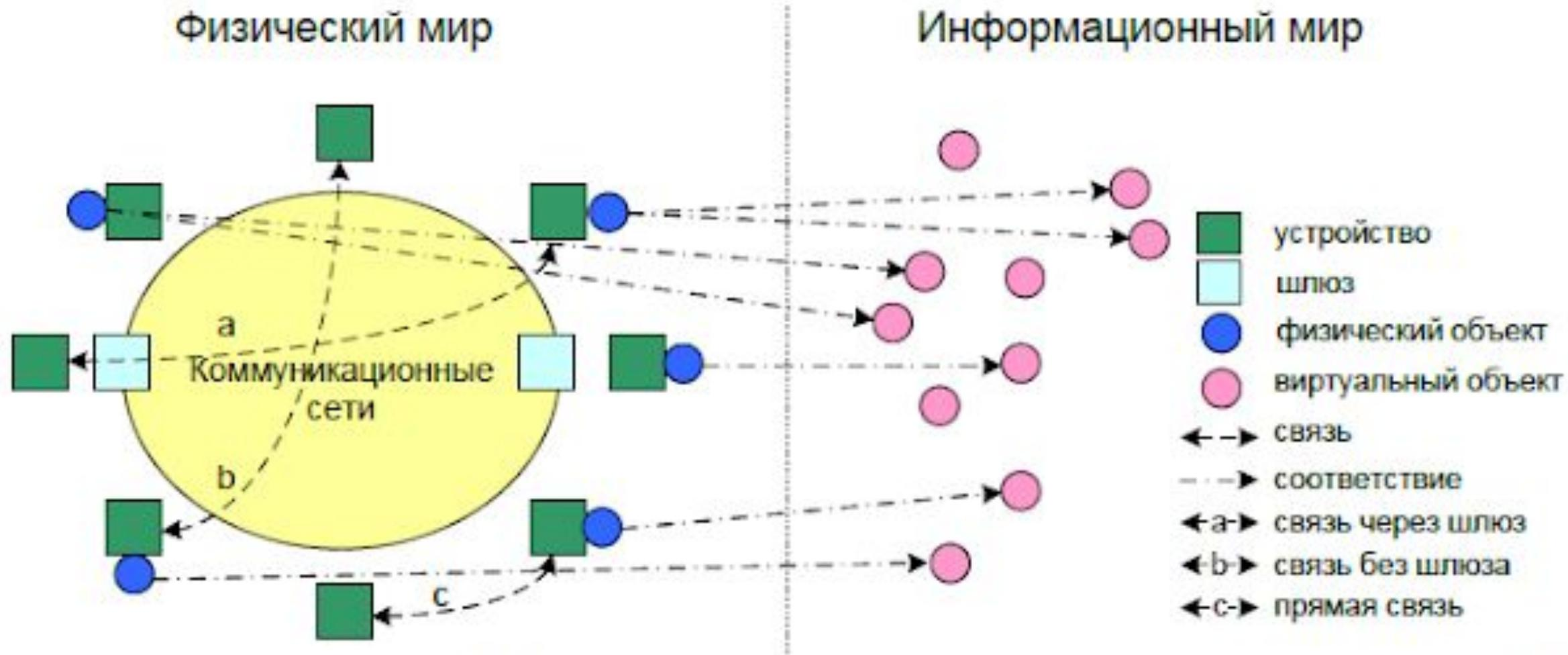
Схема отображения физических и виртуальных вещей
