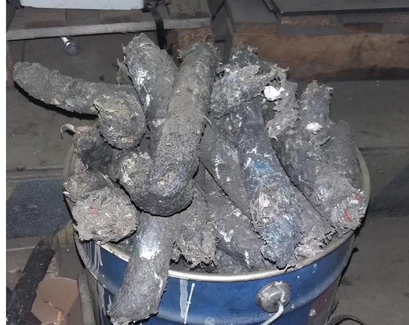
В результате формования были получены гранулы, однако из-за отсутствия автоматического регулирования скорости вращения шнека и температурной регулировки через 2 часа в экструдере образовалась пробка, из-за которой была прекращена работа машины. Трехмерное моделирование было проведено в среде PARA VIEW программного модуля YADE.
