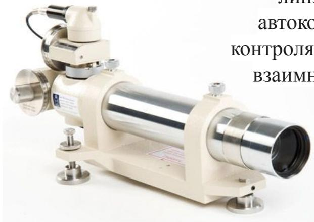
Это юстировочный измерительный прибор для измерения малых углов.
