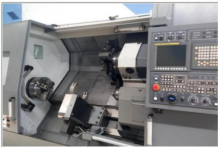
Все чаще современные станки предназначены для обработки металлов различными способами: на одном станке можно совмещать токарную и фрезерную обработки.
