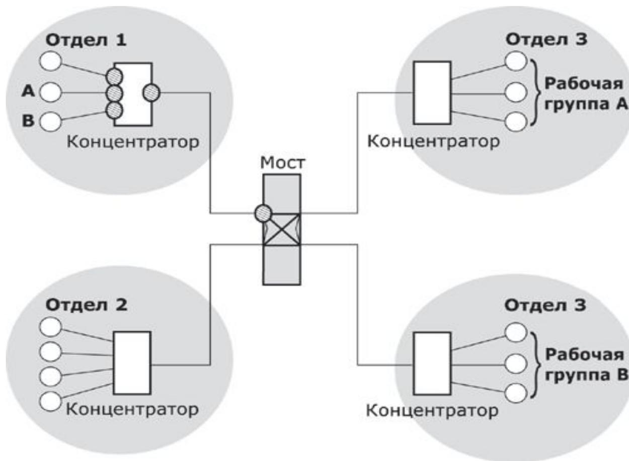
Делит разделяемую среду передачи сети на части, передавая информацию из одного сегмента в другой только в том случае, если такая передача действительно необходима
